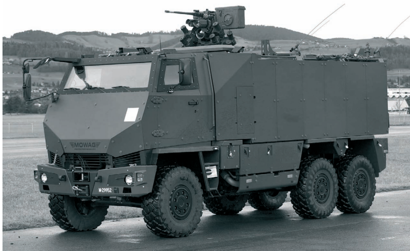
Véhicule protégé de transport de personnes GMTF (DURO IIIIP, 6x6)
