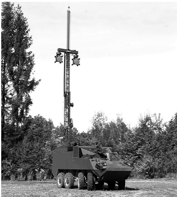
Char RAP avec mât intégré et antennes montées fixe
