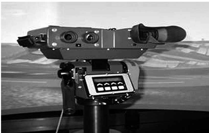
Installation électronique d'instruction au tir; station de mensuration et d'observation des buts
