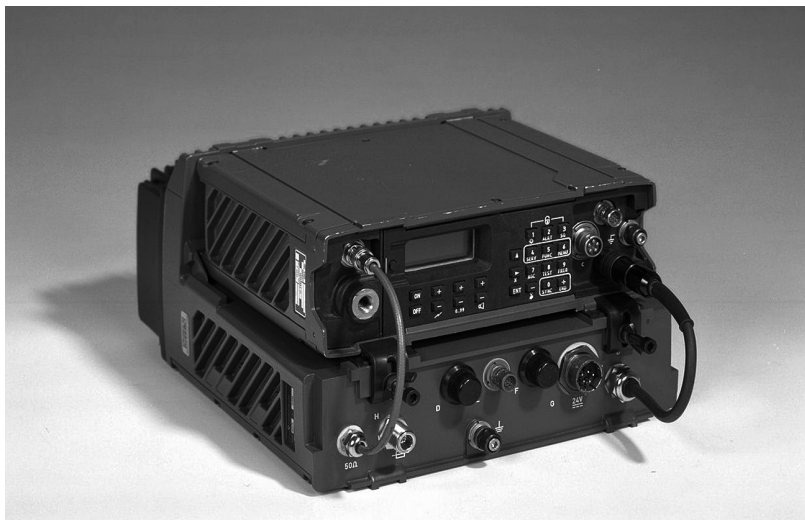
Système radio HF SE-240 (niveau de puissance 125 watts)
