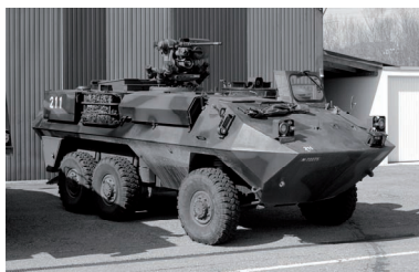
Véhicule de commandement SIC (chasseur de chars 90, PIRANHA I, 6x6, transformé)
