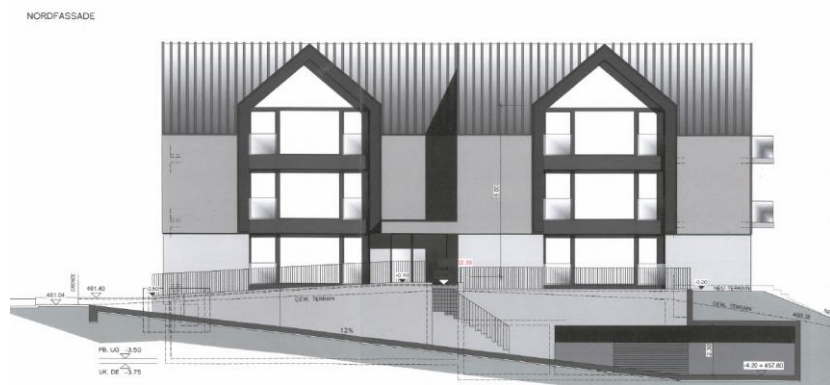
Plan «Nordfassade», Massstab 1:100
