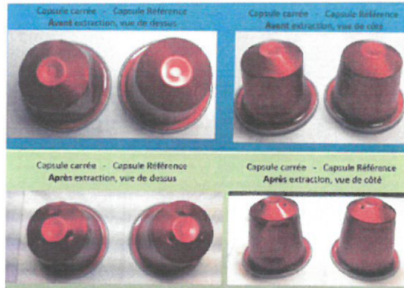
Figure 3 Vues du haut et de côté de capsules NNO, déformées en carré et circulaires (représentation du haut), puis après extraction de café dans une machine NNO (représentation du bas). On constate que la capsule déformée tend à reprendre sa forme à section circulaire sous l'effet de la pression de l'eau. Les empreintes et déformations circonférentielles provoquées par les harpons du compartiment à capsule sont également visibles.
