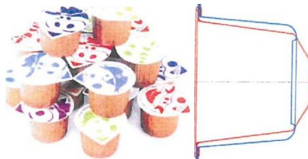
Figure 22 Capsules de crème à café [...] (à gauche [10]). Superposition de deux sections de capsules (à droite), capsule NNO (en trait rouge) comparée à une capsule de crème [...] (en trait bleu). Le diamètre extérieur de cette dernière est quasiment identique, la capsule peut transiter par le châssis de la machine NNO (sans fermeture du mécanisme).
